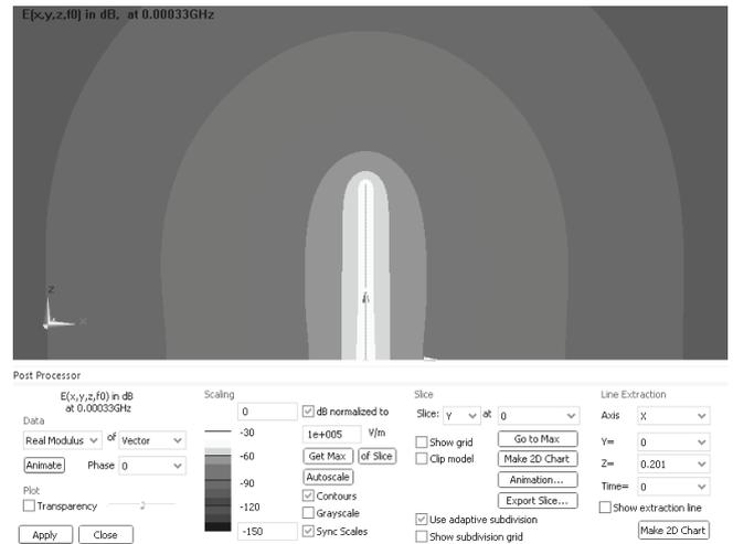
**Figura 13** Distribuzione del campo elettrico supponendo il cavo verticale carico e caratterizzato da una ddp di 100V rispetto a terra.
