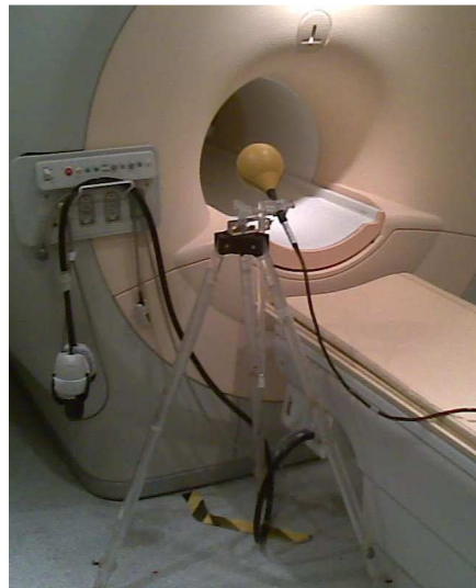
Figura 5: posizionamento del sensore durante le misure
