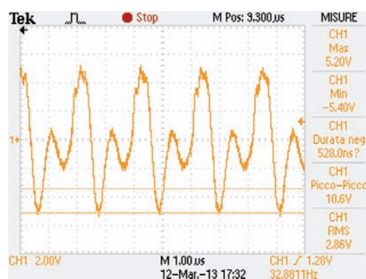
Figura 6. Elettrobisturi Alsa Excell MCDS, modalità taglio, forma d'onda della tensione su una resistenza di carico anti-induttiva di alcune decine di ohm.
