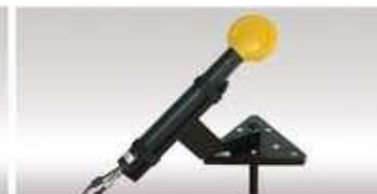
단속 H-field Probe(별매)
