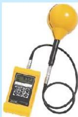
Alcuni strumenti (p.es. Narda ELT-400, PMM EHP-50E) forniscono direttamente l'indice di picco ponderato riferito ad alcune normative pre-impostate. L'utilizzo di una catena strumentale *ad-hoc* permette però maggiori flessibilità e versatilità, specie per indagini con finalità di approfondimento e ricerca.
