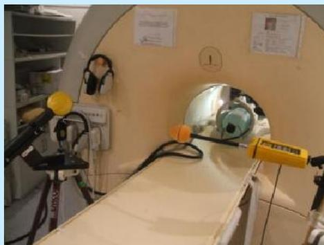
L'esposizione ai CMG è stata valutata nelle posizioni all'interno della sala magnete in cui è possibile che un operatore debba stazionare durante le procedure mediche, oppure in punti di test particolarmente significativi perché in grado di documentare la massima esposizione possibile al di fuori del *bore*.
