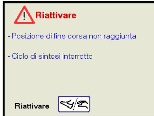
*Posizione di fine corsa non raggiunta* – Per completare il ciclo di fusione sono necessari altro tempo ed energia.
